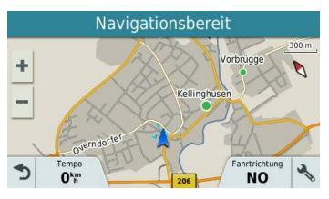
Der 2D Kartenmodus mit Geschwindigkeitsanzeige und Fahrtrichtung. Der Pfeil symbolisiert deine Position und Richtung.
